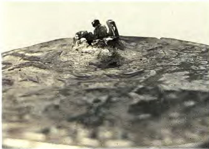
Die beim Lochen entstandenen Grate in unbearbeitetem Zustand.
