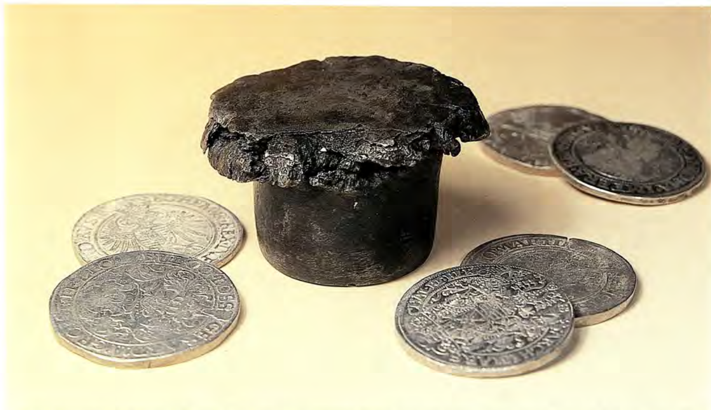
Stark abgenutzter, nicht mehr zum Prägen verwendbarer Oberstempel. Durch die wechtigen Hammerschläge entstand der überkragende Wulst.
