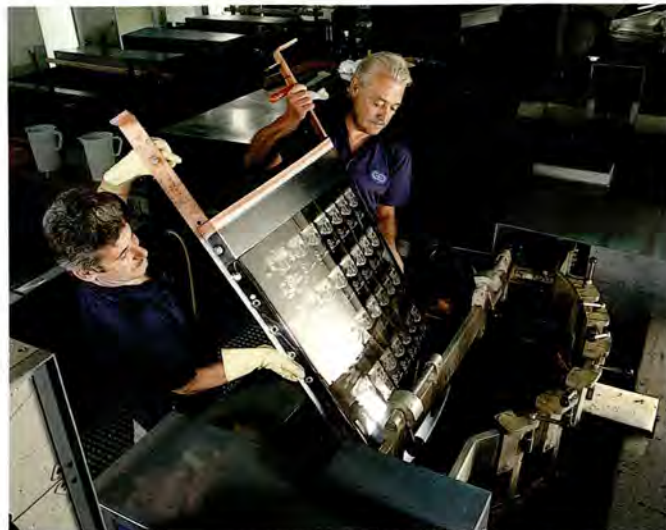
In einem galvanischen Prozeß werden die zur Herstellung der Banknoten verwendeten Stahldruckplatten gefertigt
