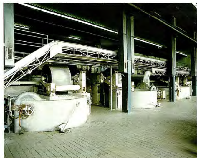
Mahlwerk zur Zerkleinerung der Baumwollfasern (Holländer)
