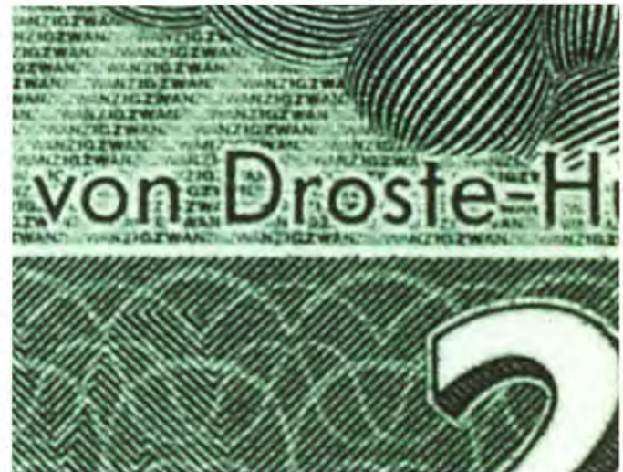
Mit dem bloßen Auge kaum erkennbare Mikroschrift. Die Ausschnittvergrößerung läßt die saubere Druckausführung der Mikroschrift auf einer echten Banknote erkennen
