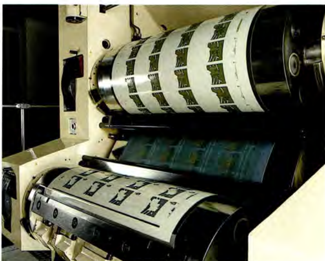
Indirekter Hochdruck auf einer Supersimultandruckmaschine
