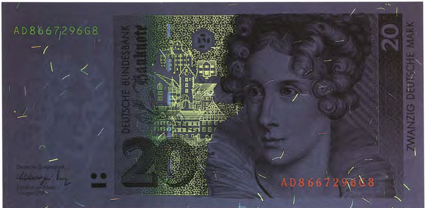
Fluoreszierende Fasern im Banknotenpapier unter Beleuchtung mit ultraviolettem Licht
