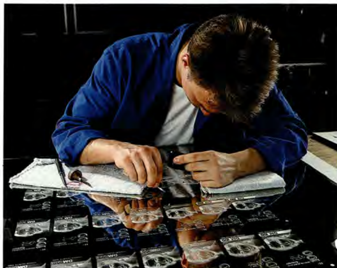
Eine sorgfältige manuelle Überarbeitung der Platten vor ihrer Verwendung garantiert ein präzises Druckbild
