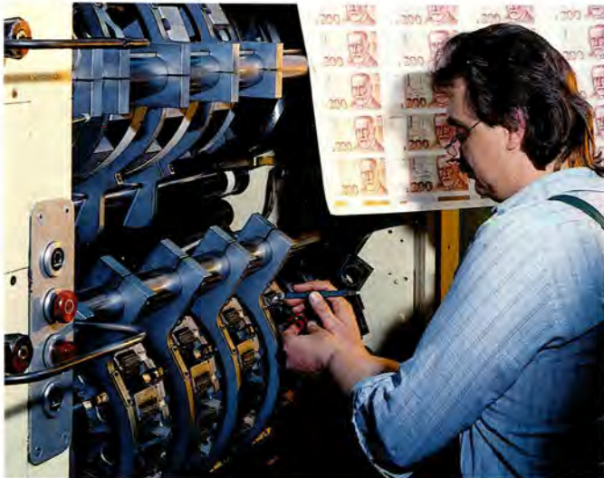
Numerierwerke versehen jede Banknote mit einer Kombination aus Buchstaben und Zahlen. Mit Ausnahme des 5 DM-Scheines gibt es je Nennwert 10 Milliarden Möglichkeiten der Zusammenstellung
